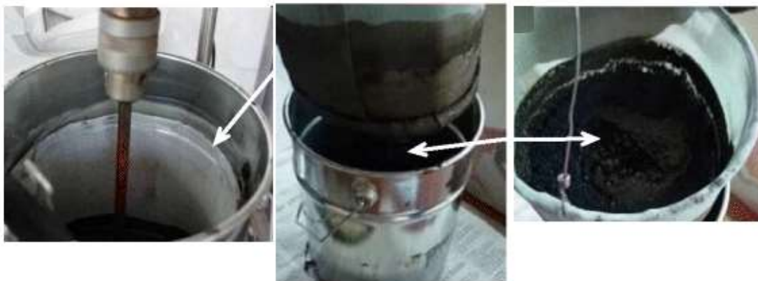
1-rasm. Bitumlarning reologik xossalarini o’rganishga namunalarni tayyorlash.
